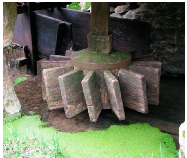
Middelaldercenterets rekonstruerede vandmølle med vandret skovhjul på en lodret aksel.
